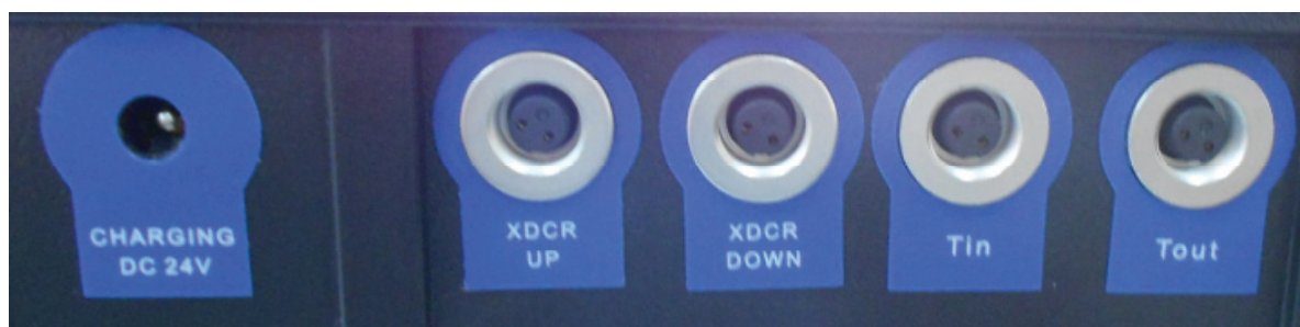
Anslutningar för laddare , sensorer, temperaturgivare
